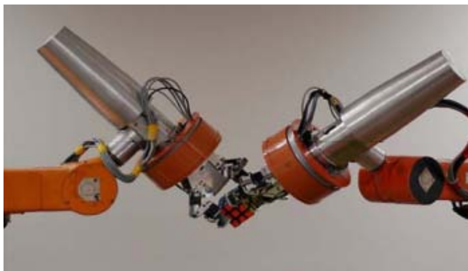
Rysunek 1: Dwa zmodyfikowane manipulatory Irp-6 układające kostkę Rubika
